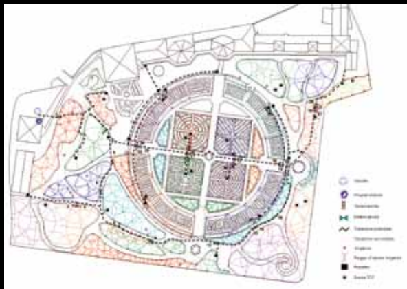
Fig.31 Schema dell'attuale impianto d'irrigazione dell'Orto.
